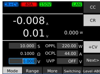
ディスプレイ左上に「CR+CV」が表示され、CR モードに CV モードが追加されます。
