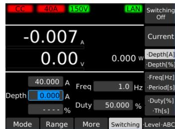
2 テンキーまたはロータリノブで、スイッチングレベル (Depth) を入力します。CC モードでは電流値 [A]、CR モードではコンダクタンス値 [S] を入力します。Depth キーを押すたびに、電流値/コンダクタンス値入力と、比率 [%] 入力が切り替わります。比率入力では、CC モード/CR モードの負荷設定値に対する比率を入力します。スイッチングレベルが設定されます。
