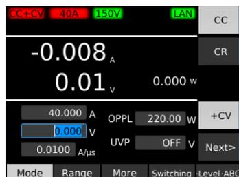
ディスプレイ左上に「CC+CV」が表示され、CC モードに CV モードが追加されます。
