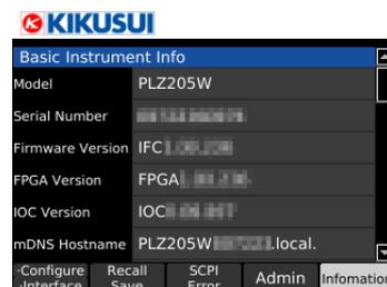
IP Address には、インターフェース設定 (p.91) の IP Address > Method が Automatic で接続が完了している (ディスプレイの LAN 接続状態アイコンが緑) 場合、自動的に割り振られた IP アドレスが表示されます。
